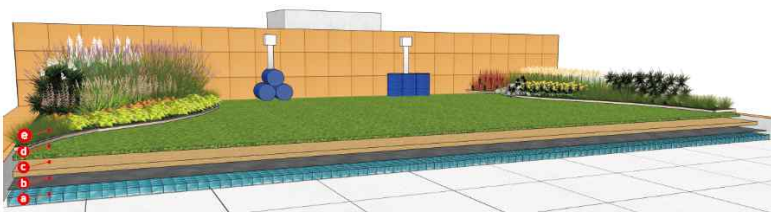
● a 빗물저금통 ● b 습도유지필터 ● c 마사토 ● d 천연잔디보호매트 ● e 조경식재
