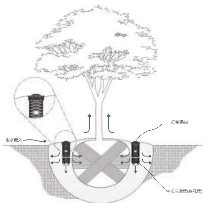
雨水渗透 生长三通管(有孔管)
