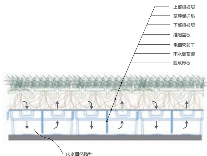
雨水循环 屋顶绿化系统
