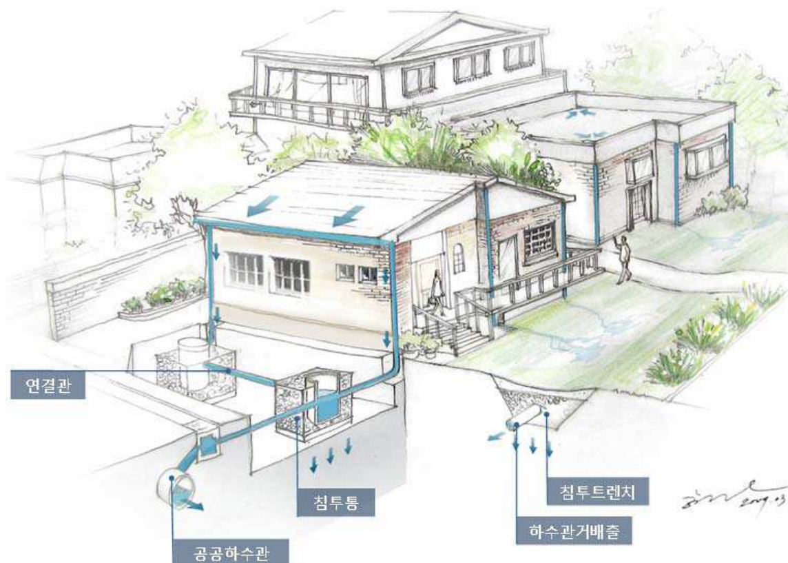
[그림 4.3-1] 단독주택의 침투시설 설치 구조
