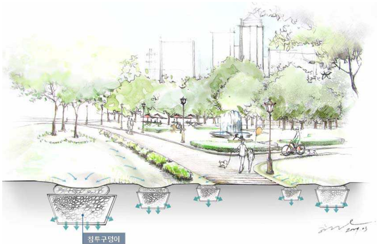
[그림 4.3-15] 공원의 침투시설 설치 구조
